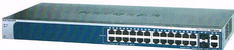
Rys. 3.5a Przełącznik sieciowy L2 – 24 interfejsy Gigabit Ethernet
